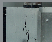
Condição após 760.000 ciclos de carga com HaTelit C (PET)
